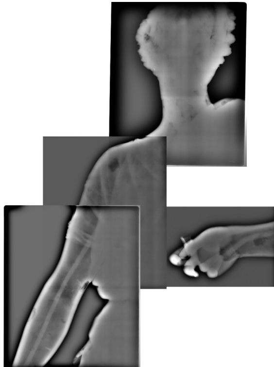
FIGURE 2.16 – Radiographie gamma de la partie droite du buste et de la main gauche de la statue de la Prudence (voir figure 2.15). L'épaisseur de la paroi métallique varie de 8 à 18 mm dans le bras et de 25 à 40 mm dans la tête. Source : Castelle (2016). © C2RMF.
